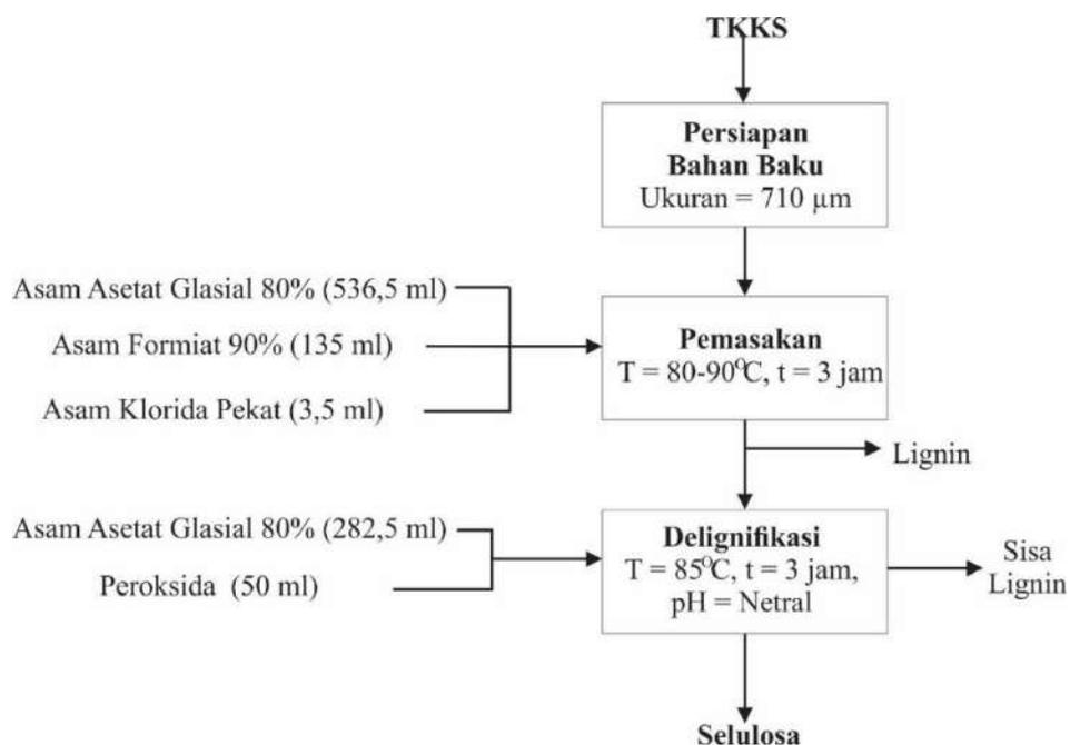
Gambar 3.2 Diagram alir isolasi selulosa dari tandan kosong kelapa sawit (TKKS)
